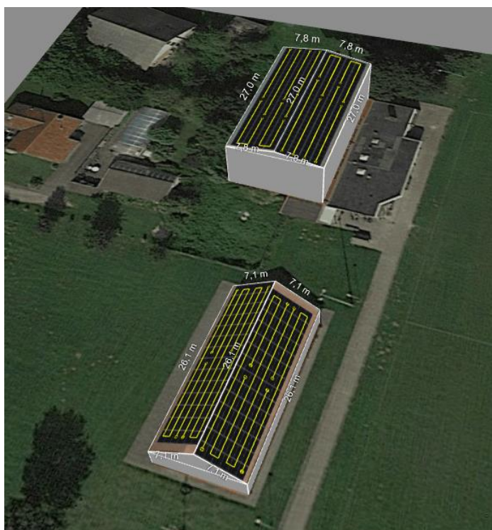
Abbildung 27: Ansicht der Modulauslegung Walcotthuus & Sporthalle
