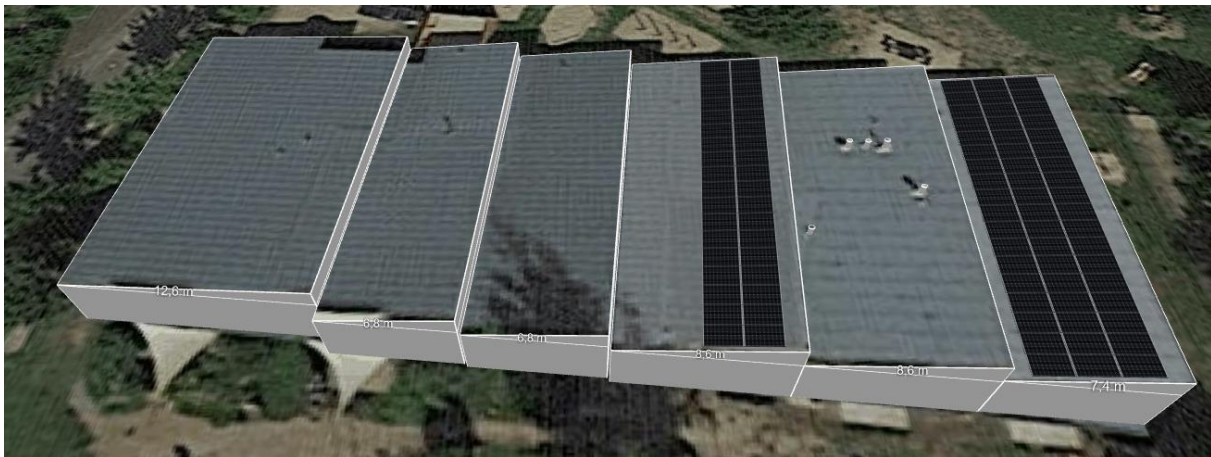
Abbildung 40: Ansicht der Modulauslegung (31 kW p )
