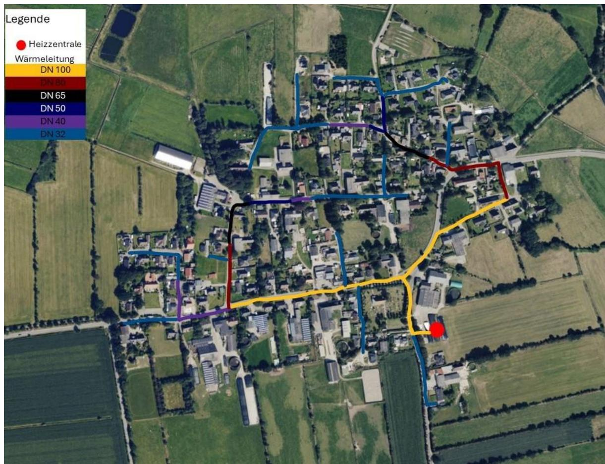
Abbildung 4-13: Dimensionierung eines Wärmenetzes im Quartier Olderup
