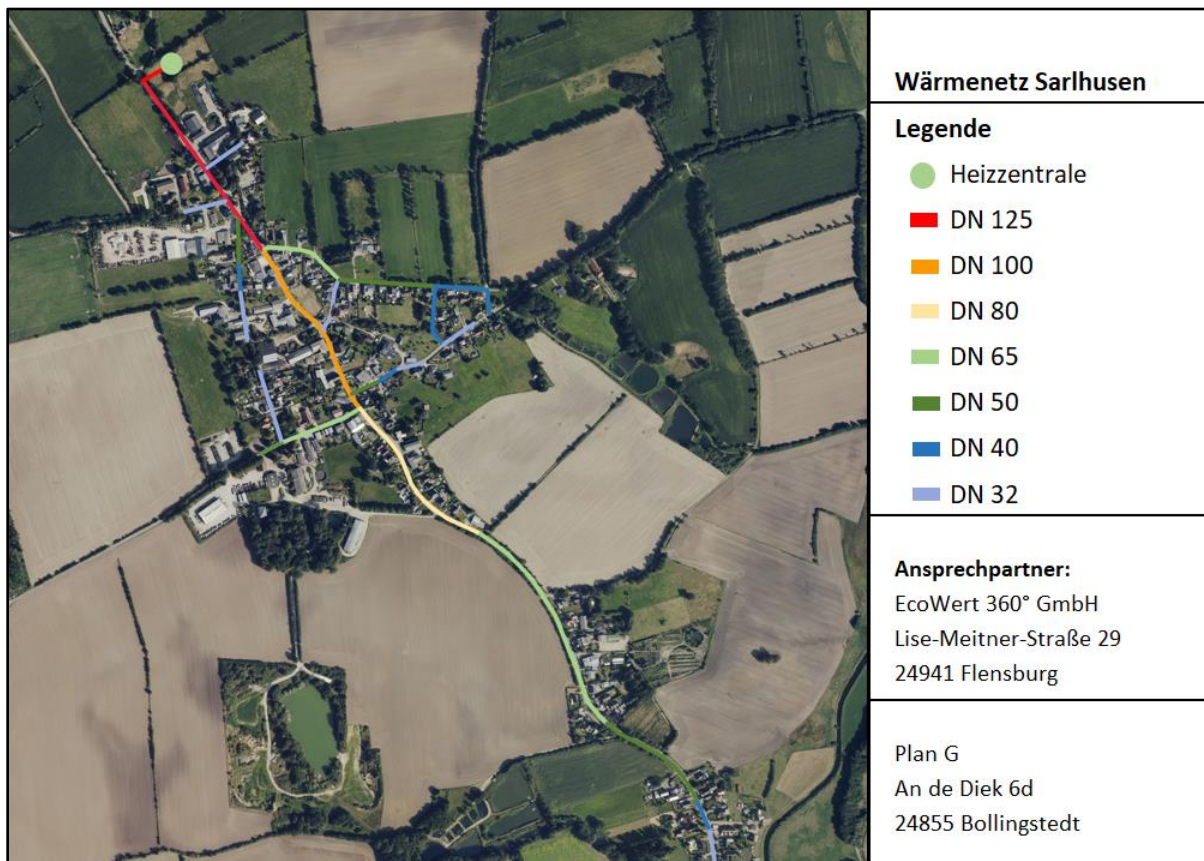
Abbildung 4-17: Dimensionierung eines Wärmenetzes im Quartier Ortskern Sarlhusen
