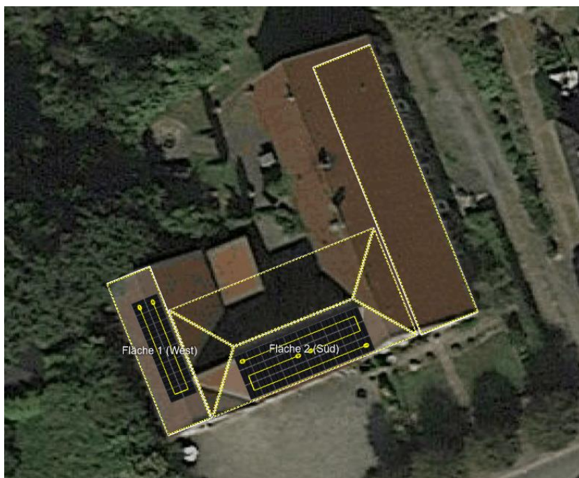
Abbildung 4-9: Auslegung PV-Dachanlage Feuerwehrhaus / Ole School
