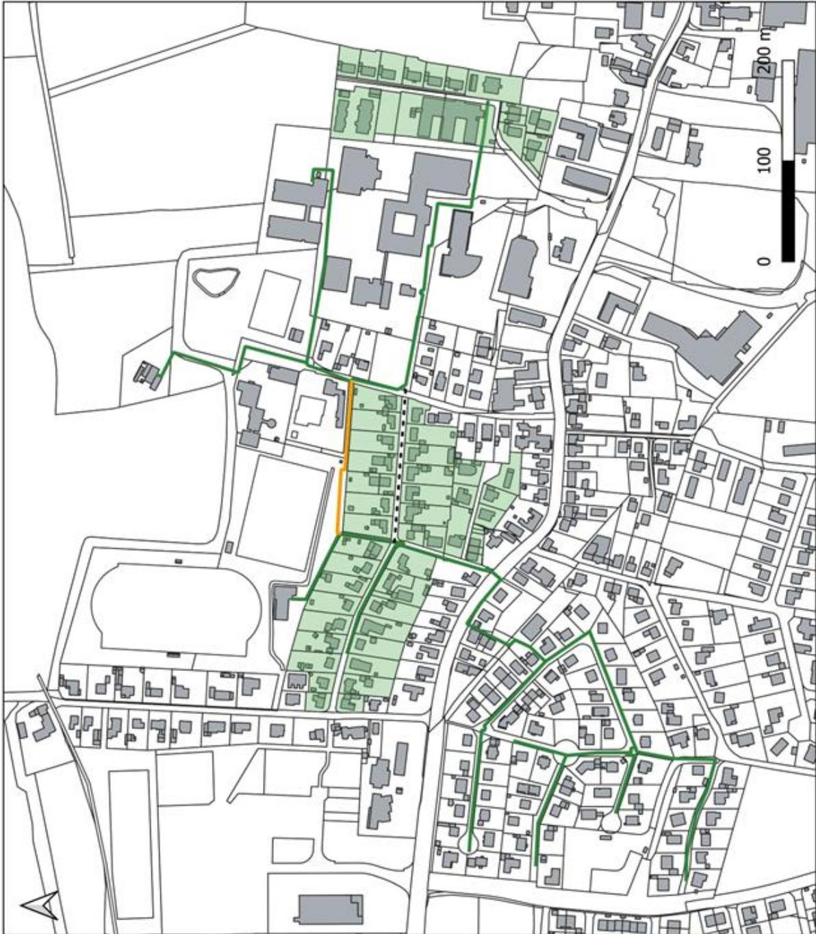
Abbildung 4-11: Bestandwärmenetz der BEVS mit möglichen Gebieten zur Erweiterung
