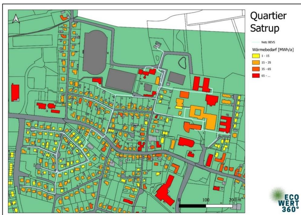
Abbildung 3-2: Netzstruktur nördliches Bestandswärmenetz Satrup
